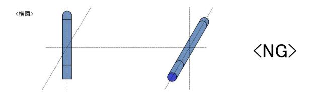
③ 送信側、受信側のアンテナの片側が両偏波放射型のアンテナ(TWE-AN-BP01など)の場合。
