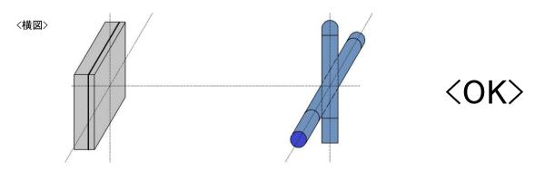
・両偏波放射型アンテナの受信感度は対となるアンテナの向きに左右されにくい特性を持っています。
